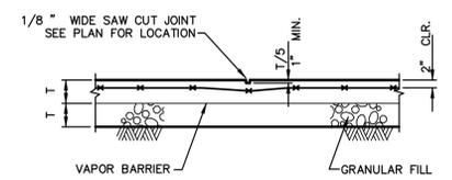
**TYPICAL SLAB ON GRADE CONTROL JOINT**
