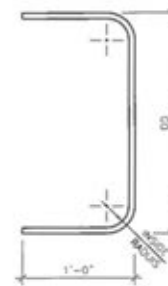
③ VERTICAL U-BAR SCALE: N.T.S.
