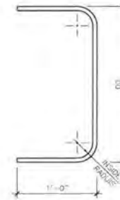
③ VERTICAL U-BAR SCALE: N.T.S.
