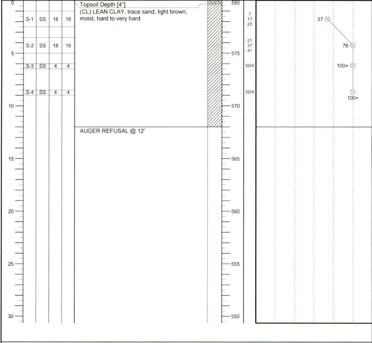
THE STRATIFICATION LINES REPRESENT THE APPROXIMATE BOUNDARY LINES BETWEEN SOIL TYPES. IN-SITU THE TRANSITION MAY BE GRADUAL.
