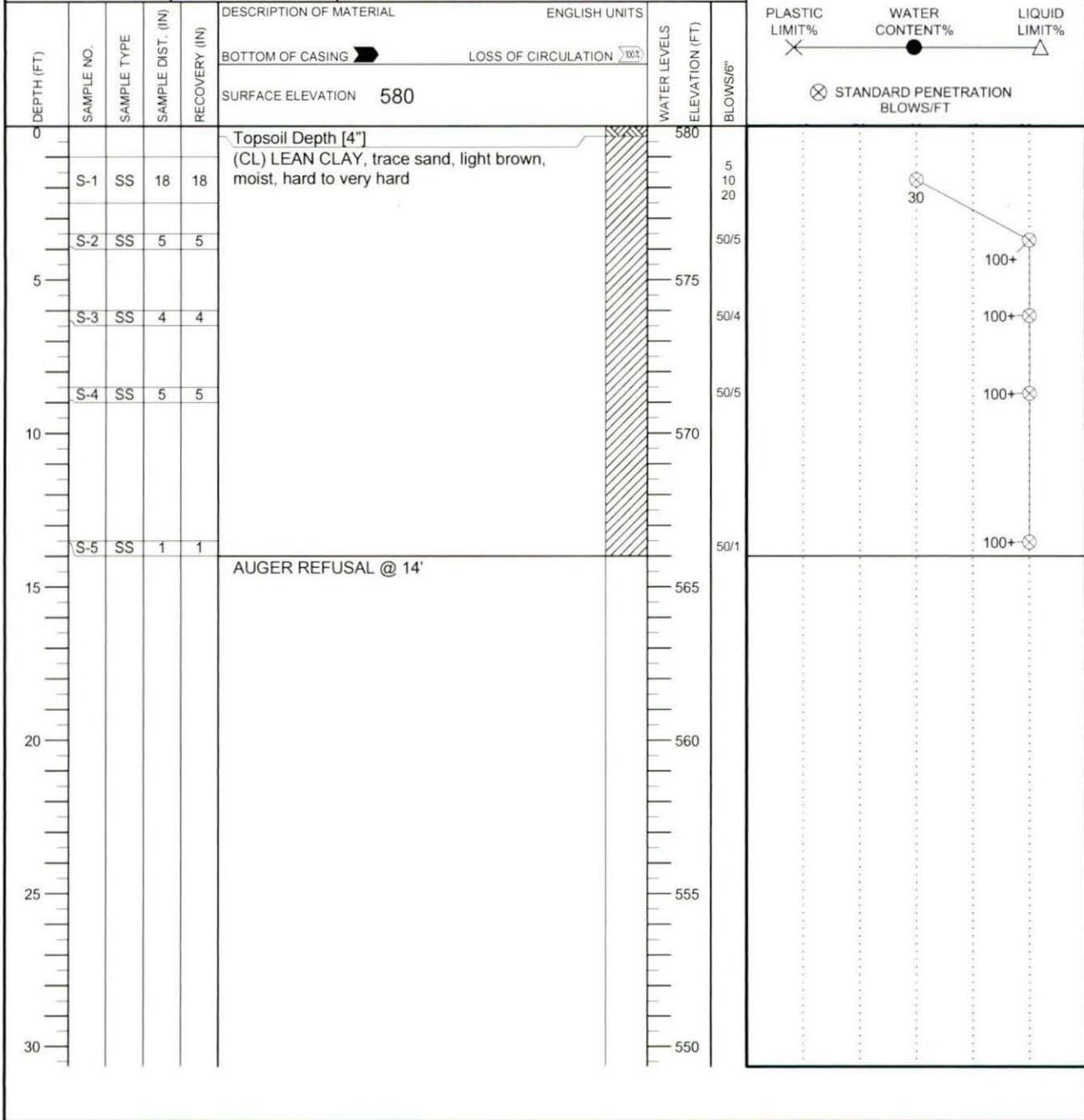
THE STRATIFICATION LINES REPRESENT THE APPROXIMATE BOUNDARY LINES BETWEEN SOIL TYPES. IN-SITU THE TRANSITION MAY BE GRADUAL.
